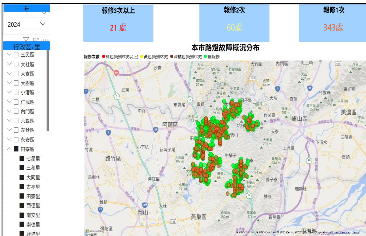
圖 4. 建置本局路燈故障視覺化查詢平台-路燈故障概況分布
