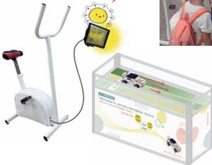
踩動腳踏車踏板發電 投射燈發亮照射太陽能小車
