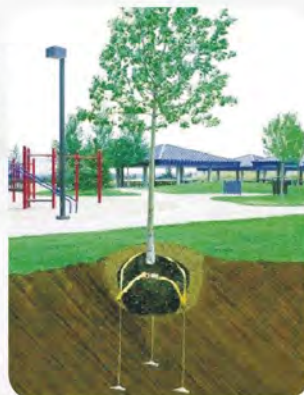
地錨式固定工法
