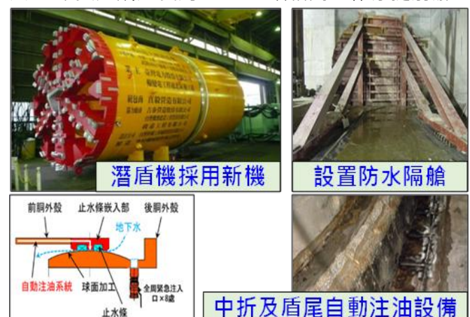
圖 16 統包階段過港段降低施工風險對策
