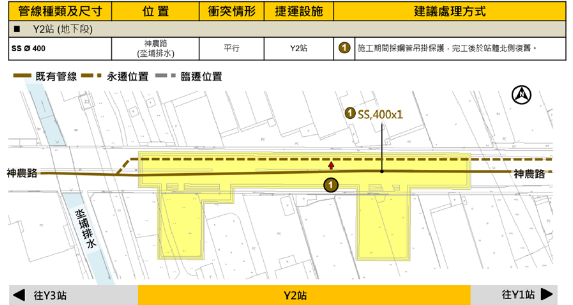
圖 14 Y2 車站(神農路) 污水管遷移對策
