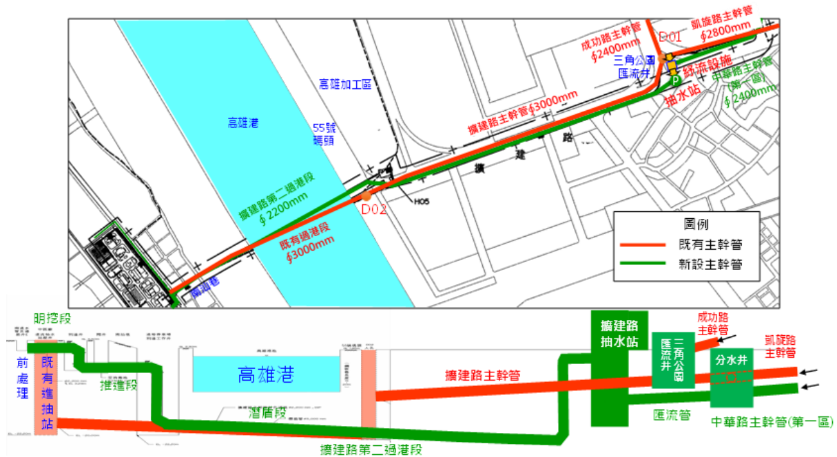
圖 5 擴建路污水主幹管(第二過港段)抽水站位置-方案 B
