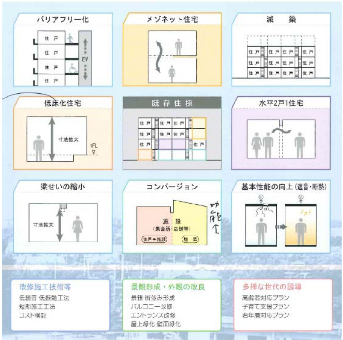
圖 7 UR 都市機構樣既有住宅改造手法
