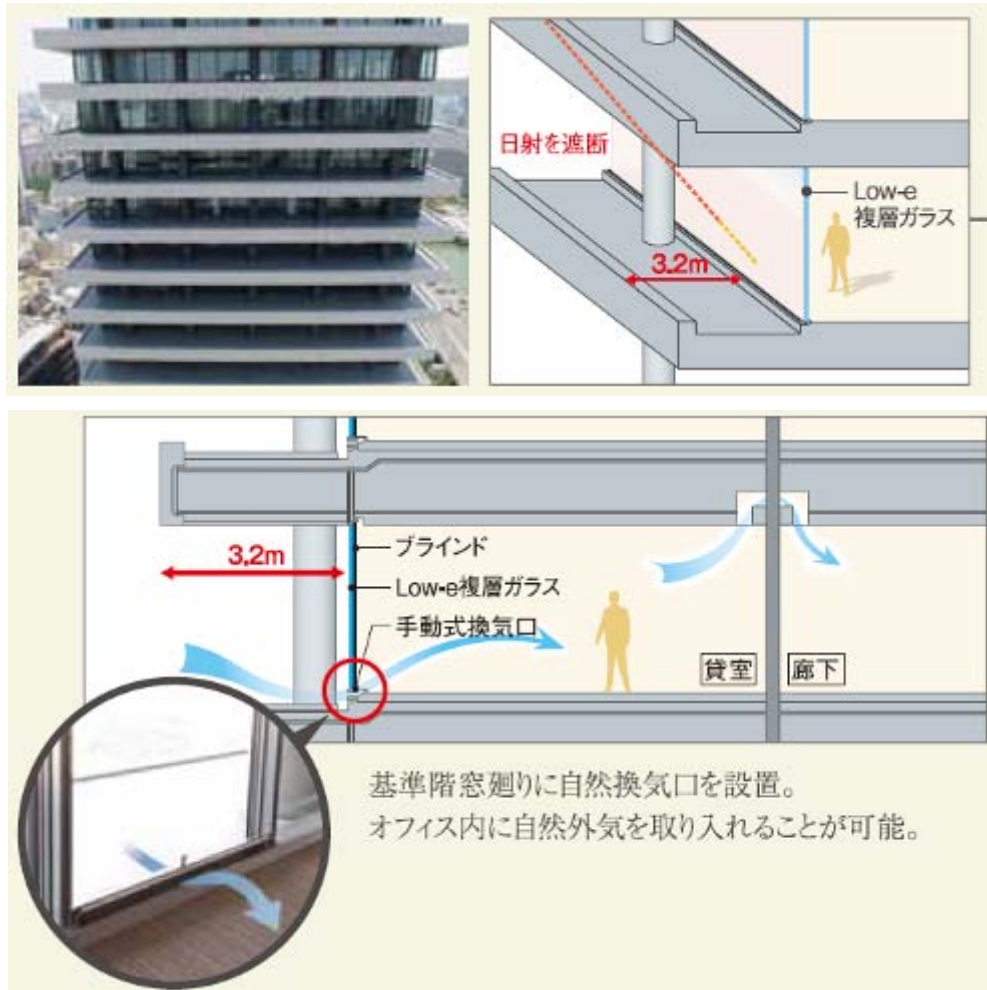
圖 60 結構、深遮陽、換氣口、LOE-E 玻璃降低室內空調負荷 (資料來源:日建設計樣提供)
