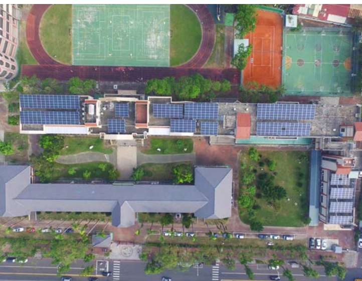
| 學校類建築 | 高雄市三民國小 設置地點 / 高雄三民區 設置類型 / 學校類 設置 容量 / 151.74kwp 發電量 / 193,847 度 / 年 減少二氧化碳排放量 / 約 101,188 噸 / 年
