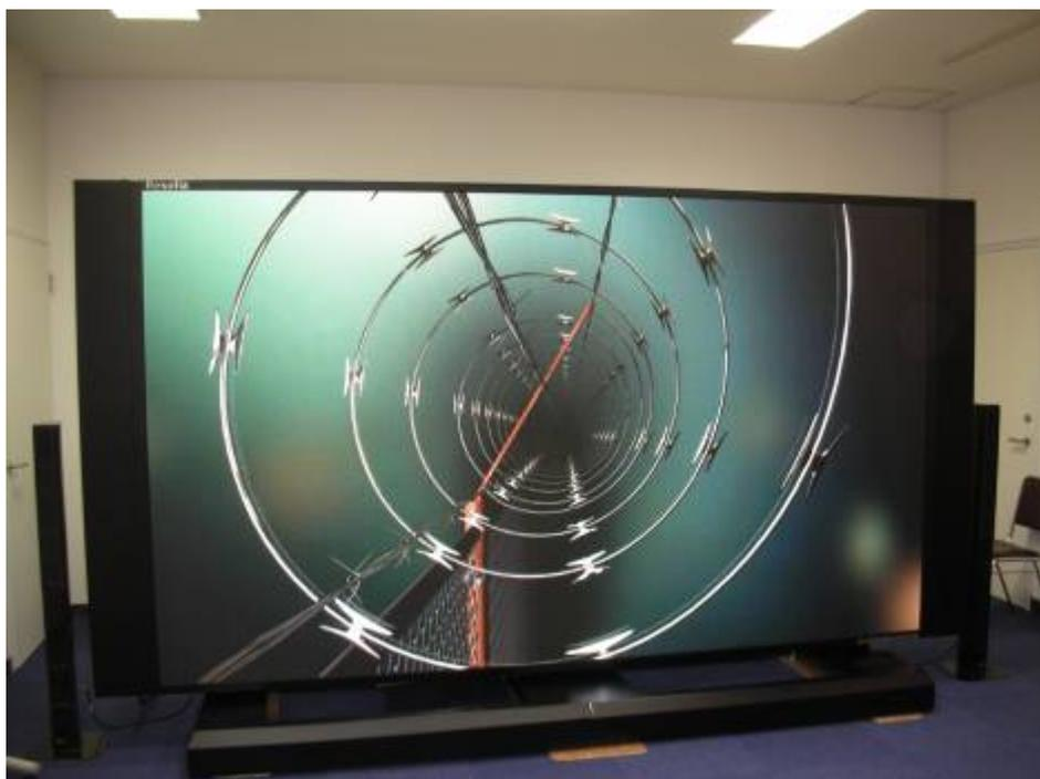
日本三菱電機 LED 全彩顯示幕最新產品燈點間距 4mm
