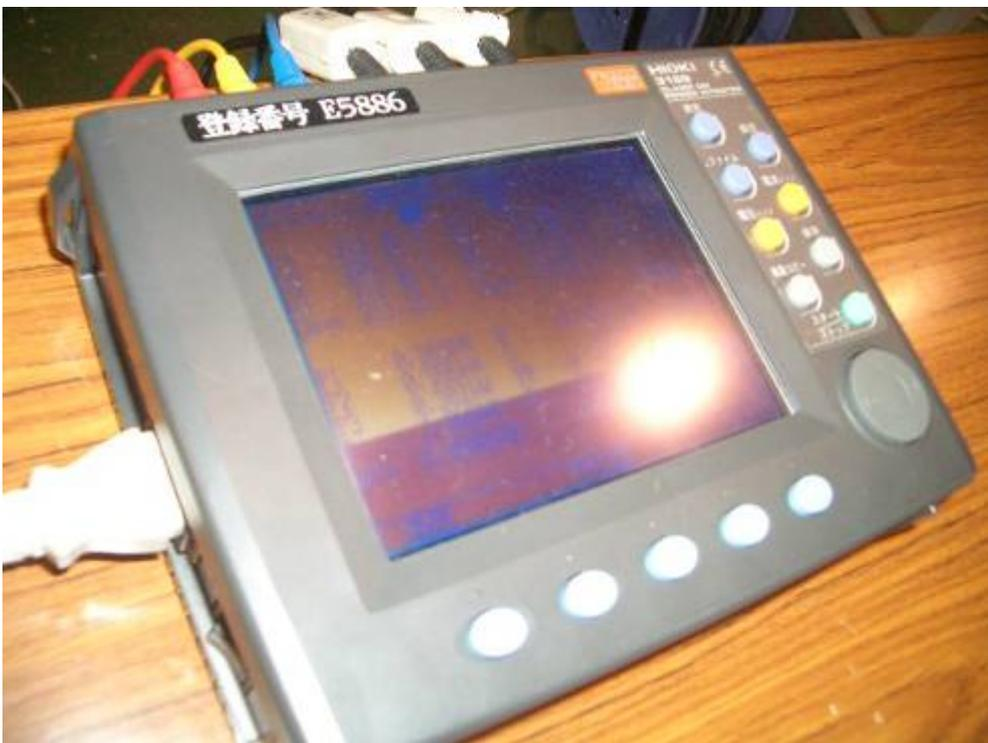
LED 模組運轉電壓、電流、頻率量測
